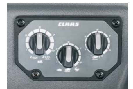
Dragkraftsreglering, sänkhastighet och lyftbegränsning justeras bekvämt på den högra konsolen.
