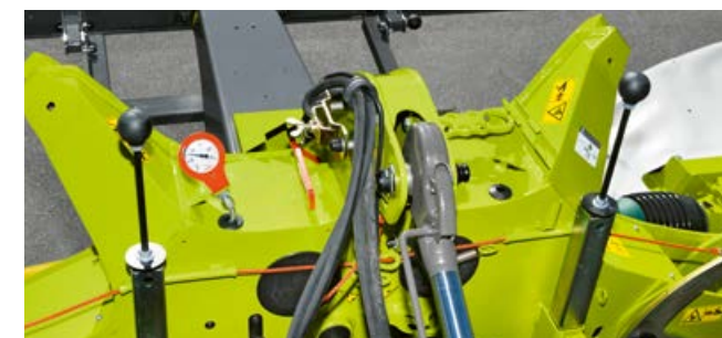
Manometer för enkel inställning av anliggningsstryck för båda slätterenheterna.
