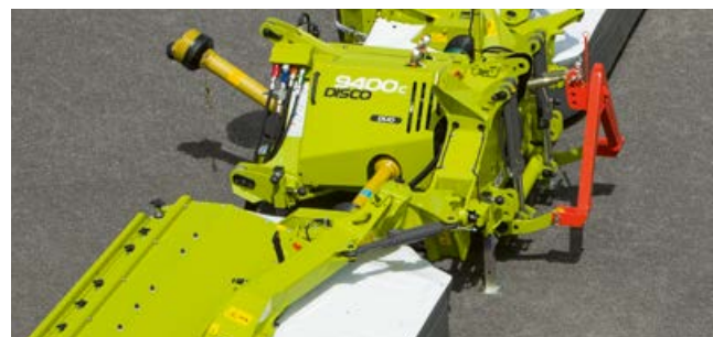
Hydrauliskt nonstop påkörningsskydd – slåtterenheter svänger upp och återgår automatiskt till utgångsläget.
