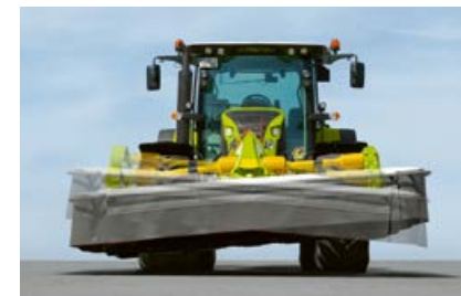
Pendelupphängning ger perfekt markföljning i sidled.
