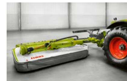
Med hydrauliskt styrda armar, kan arbetsbredden varieras mellan 9,40 m till 10,70 m, beroende på vilken frontslåtter som används.
