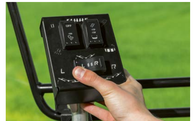
DISCO 1100 TREND med manöverenhet för individuellt lyft, för uppfällning till transportläge, samt (som tillval) en funktion för arbetsstrålkastare on/off.
