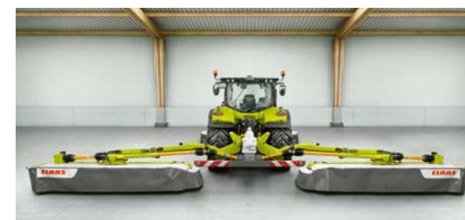
DISCO 1100 TREND, två hydrauliskt manövrerade teleskopiska armar med steglös inställning för optimal överlappning.
