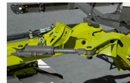
Hydrauliskt nonstop påkörningsskydd – maskinen svänger bakåt/uppåt och återgår automatiskt till utgångsläget.
