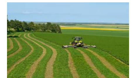
Optimalt arbetsresultat även vid snäva svängar med justerbar överlappning (upp till 60 cm).
