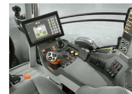
Styrning av förval för CONTOUR kan utföras direkt via traktorns ISOBUS terminal.
