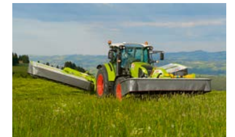
Kompakt trepunktsupphängning ger slåttermaskinen hög markfrigång på vändtegen.
