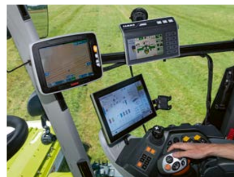
Bekväm manövrering via ISOBUS terminalen S10 eller körspakens ISOBUS funktionsknappar.
