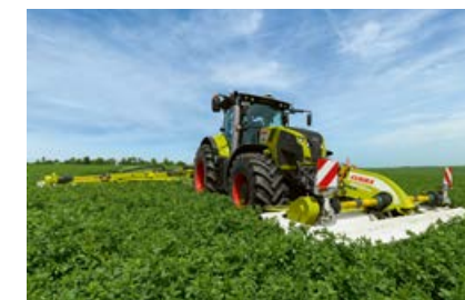
Tillval för frontslåttermaskinen är t ex varvtalsövervakning, ACTIVE FLOAT styrning och fällbara skyddsdukar.
