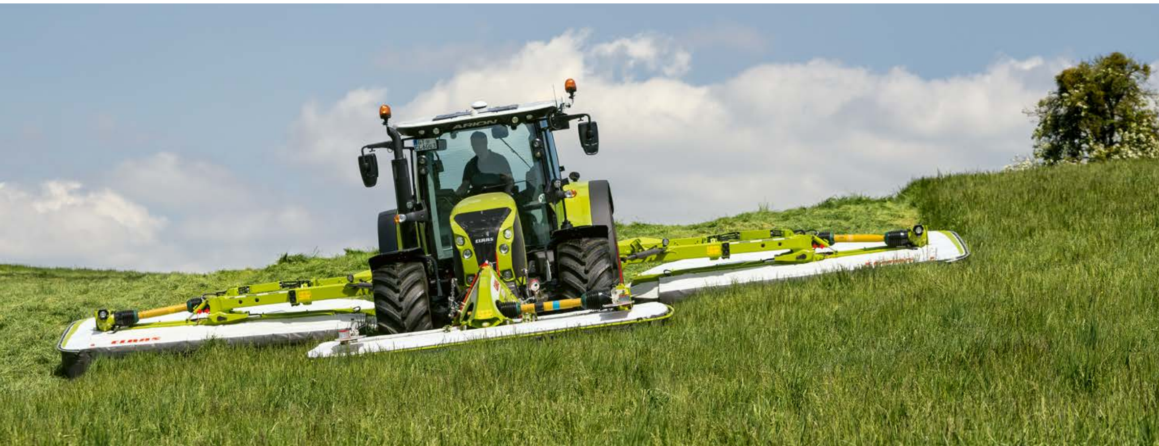
DISCO 1100 TREND med manöverenhet för individuellt lyft, för uppfällning till transportläge, samt (som tillval) en funktion för arbetsstrålkastare on/off.
