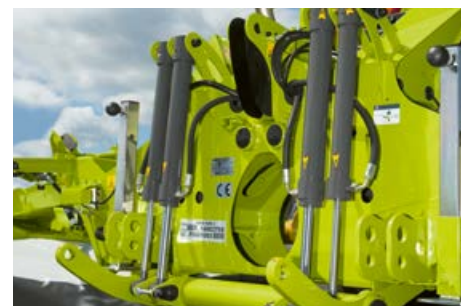
Kolvar för lyftning av slåttermaskinen och avlastning i ACTIVE FLOAT systemet är standard och garanterar skonsamhet mot gräsvallen.
